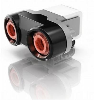
Датчик ультразвука, который позволяет определять препятствия и расстояние от стенок лабиринта.
