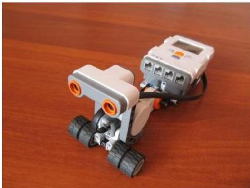
В голове конструкции расположен ультразвуковой датчик расстояния для обнаружения препятствий. Программа составлена так, что при движении робота вперед считает количество циклов движения до обнаружения препятствия, затем переключается на движение назад и повторяет количество циклов, которые робот сделал вперед. При этом внутри цикла происходит последовательное управление всеми сервоприводами по разработанному алгоритму.
